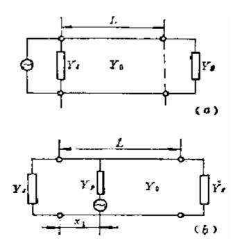
在上面的等效电路中,(a) 是带线馈电方式,其中Y-是缝隙辐射导纳,Y0是 微带片的特性导纳。(b) 是同轴线的馈电方式,探针从接地板穿孔引出,称为底部馈电。两种等效电路的不同之处在于,同轴馈电的馈点在微带片的开口端之间馈电,激励源与开始端有一段距离x1,探针本身会引入感抗y0。
