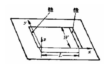
$L = \frac{\lambda_{m}}{2}$  根据上面的两点假设,当 时,两缝上的切向电场都是**\$**方向,并且等幅同相。它们等效为磁流,由于接地板的作用,相当于有两倍磁流向上半空间辐射,缝上的等效磁流密度为:
