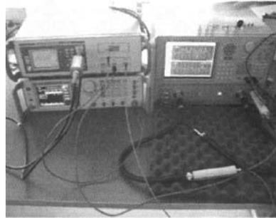
图 13 基于混频器的 NVNA 原型样机及校准组件
