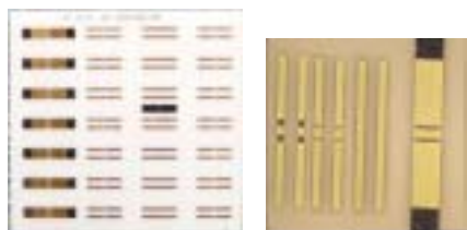
图6 ISS CS-10 标准阻抗基片结构示意图
