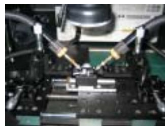
图7 探针台结构示意图
