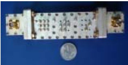
图4 矩形双模滤波器样品
