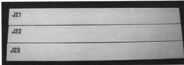
图 5 温冲试验后样板（增加了喷涂清漆）
