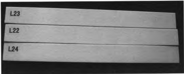
图 4 温冲试验后样板（原油漆工艺）
