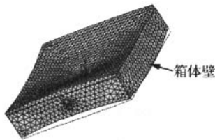
图 5 馈电箱模态振型的变形形状
