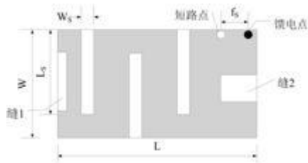
图7 改进后 PIFA 天线结构图
