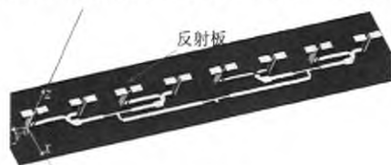
图 5 天线阵单元结构图
