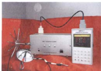
图5 GB521型中短波自动记录场强仪
