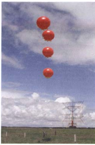
图4使用气球测垂直场形
