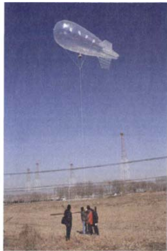
图3使用飞艇测垂直场形
