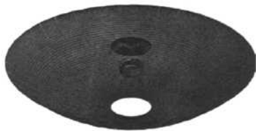
图 7 大张角波纹喇叭环焦反射面天线仿真模型
