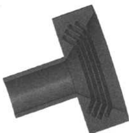
图 1 大张角波纹喇叭剖面图
