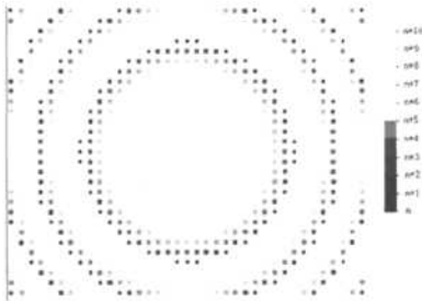
图6 C波段 FLAPS 阵列结构图
