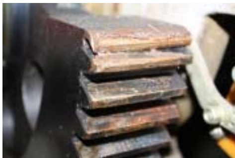
图 1 天线过冲引起的齿轮磨损图
