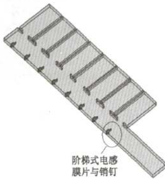
图8 8×8天线的T型结馈电网络
