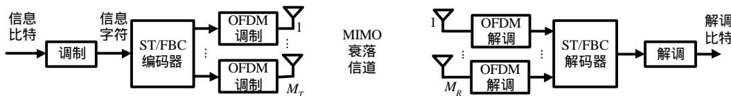
图1 采用空时/频分组编码的MIMO-OFDM系统结构示意图
