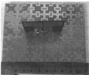
图 6 加改进型 FSS 地板的微带偶极子天线
