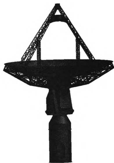
图 1 天线俯仰 90^{\circ} 有限元模型
