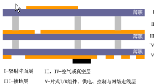
图4 微带天线结构的薄膜阵面剖面示意图
