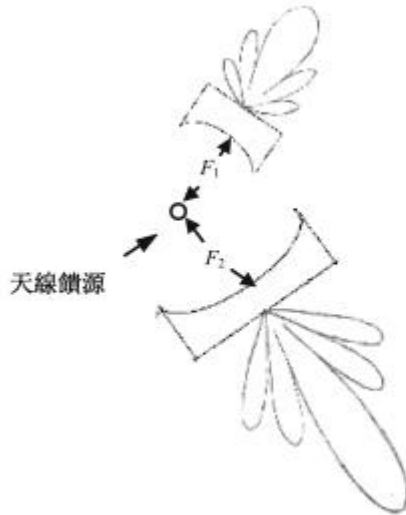
圖 7 不同曲率之凹型微波透鏡對不同之焦距產生不同指向性波束
