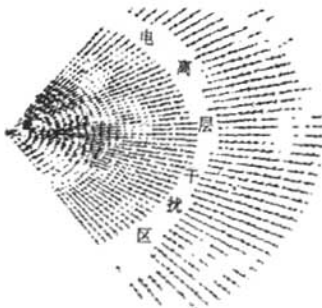
图 6 海面回波受电离层“污染”后的海流图
