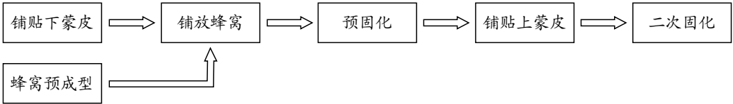
图2 天线罩二次固化工艺路线
