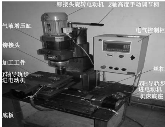
图9 数控旋柳机安装过程实物图
