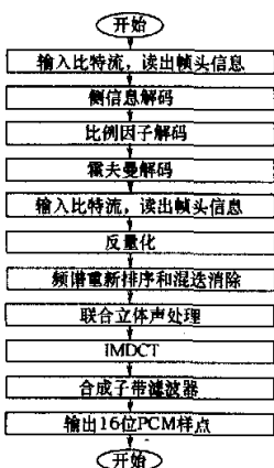
图2 MP3解码的流程图
