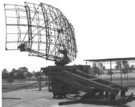
图1 某型高机动塔架式雷达升降天线
