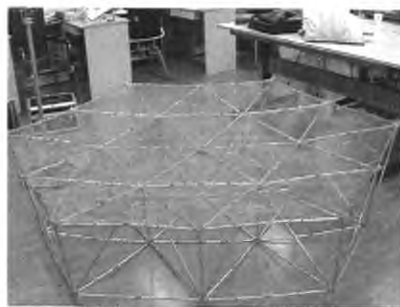
图1 四面体单元桁架式可展天线模型
