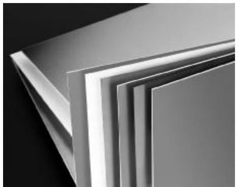
箔,从而减轻了无源互调(PIM)的影响,并实现了低插入损耗。特制的 RO4700JXR 热固性树脂系统采用空心微小球状填料,从而实现了重量轻、密度低的层压板,其重量比玻璃纤维涂覆的 PTFE 材料轻 30%左右。
