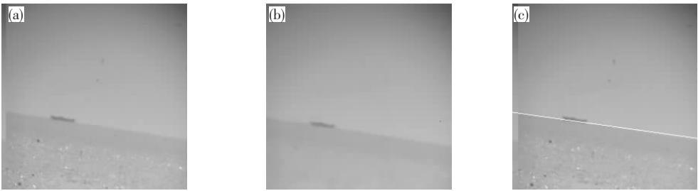
图 7 (a) 对比度不明显且海杂波稍多的图像;(b) 中值滤波结果;(c) 海天线倾斜且没有受海杂波干扰.
