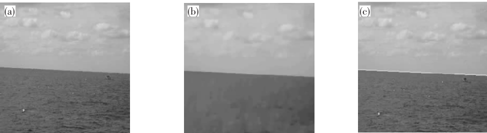
图 5 (a) 对比度明显但有大量云层的图像;(b) 中值滤波结果;(c) 海天线没有受云层干扰.
