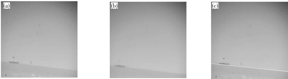
图 6 (a) 噪声较少但对比度不明显的图像;(b) 中值滤波结果;(c) 提取出的一条倾斜的海天线.
