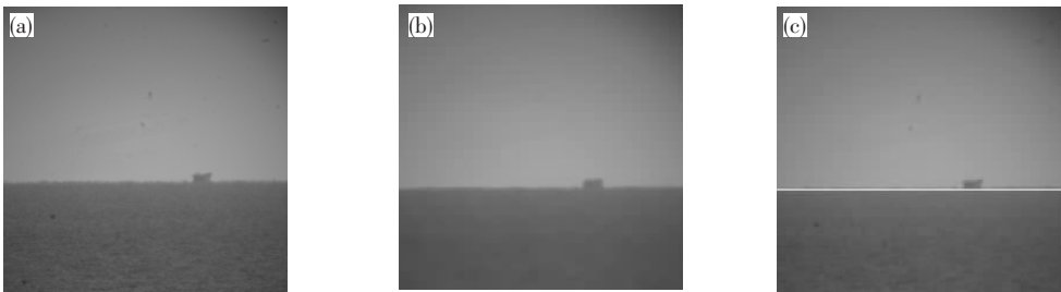
图 4 (a) 对比度明显且噪声较少的图像;(b) 中值滤波结果;(c) 提取出的一条直的海天线.
