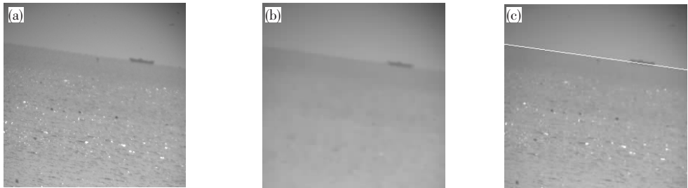
图 8 (a) 对比度不明显且海杂波较多的图像;(b) 中值滤波结果;(c) 海天线倾斜且没有受海杂波干扰.
