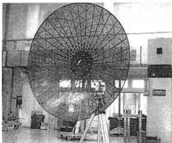
图 1 测试状态的 4200mm 柔性自回弹天线反射器
