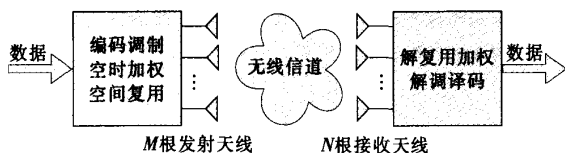
图1 智能天线收发机结构
