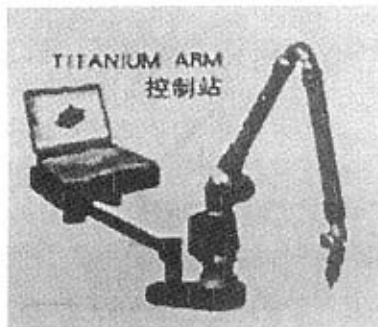
图7 三坐标测量臂工作状态示意图
