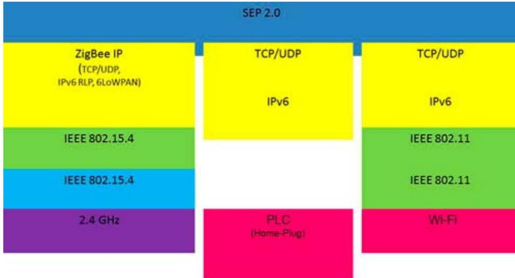
圖 1 ZigBee Smart Energy 2.0 通訊層架構
