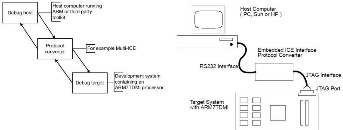
图 4. ARM7TDMI 典型的系统调试结构
