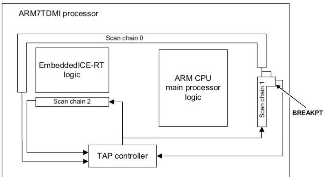
图 5. ARM7TDMI 处理器结构框图
