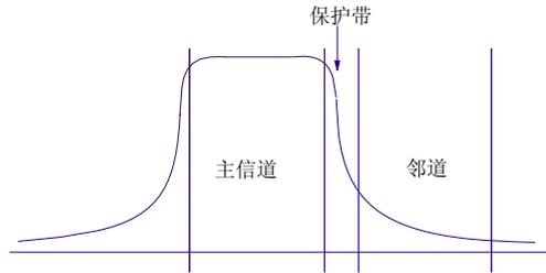
发射机的邻道泄漏必然会对其他小区造成干扰，为了减小这种干扰，邻道泄漏必须尽可能的小，WCDMA的要求是：第一邻道（偏离载频±5MHz）的ACLR≤45dBc；第二邻道（偏离载频±10MHz）的ACLR ≤50dBc。
