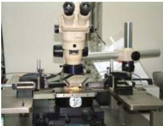
圖三、網路分析儀搭配微探針量測平台之量測環境
