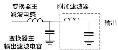
图 1.2 附加 LC 滤波获得低噪声输出
