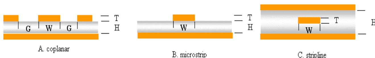
图 7.可进行特性阻抗控制的三种传输线, 图中 W 表讯号线宽, T 表讯号线厚, H 表介质层厚度, G 表同板面上讯号线与接地区之间距
