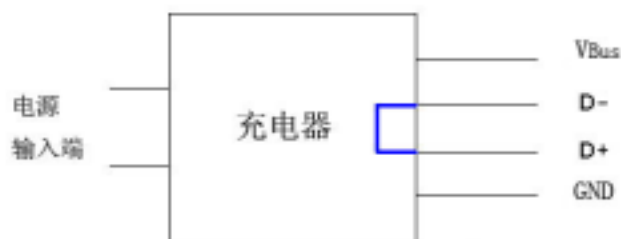
图5 充电器中 D+到 D-短接示意图
