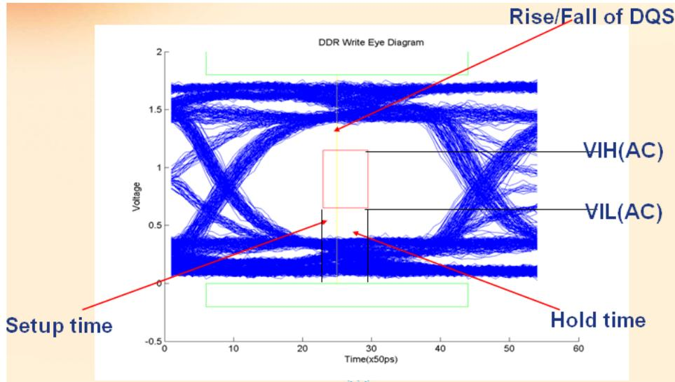
图 8: DDR2 533 “写”眼图模板的定义
