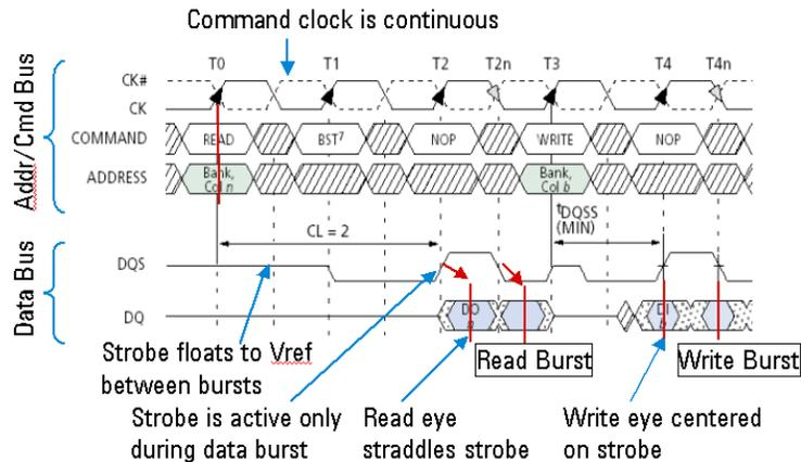
图 2: DDR 总线“读”“写”操作时序
