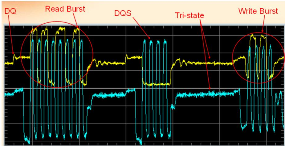
图 4: 实际捕获的 DDR2 533 DQS 和 DQ 的波形
