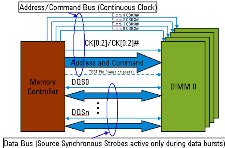
图 1: DDR 总线的体系结构
