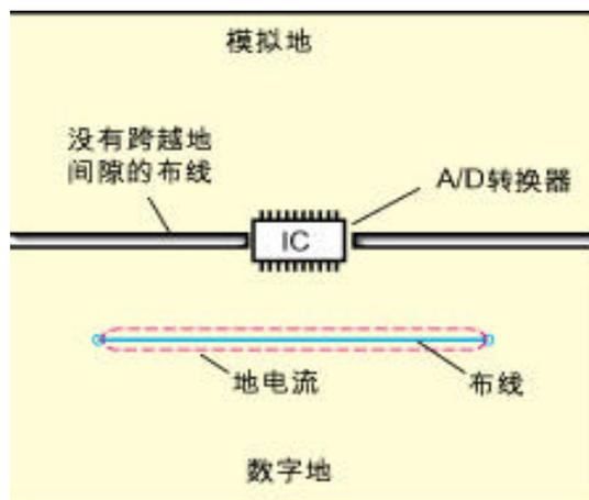
将地分割开, 在A/D 转换器下面把模拟地和数字地部分连接在一起。采取该方法时, 必须保证两个地之间的连接桥宽度与IC 等宽, 并且任何信号线都不能跨越分割间隙。
