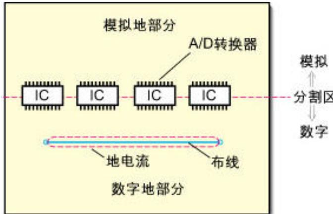
如图4 所示, 将统一的地分为模拟部分和数字部分。这样的布局布线既满足了IC 器件厂商对模拟地和数字地管脚低阻抗连接的要求, 同时又不会形成环路天线或偶极天线而产生 EMC 问题。
