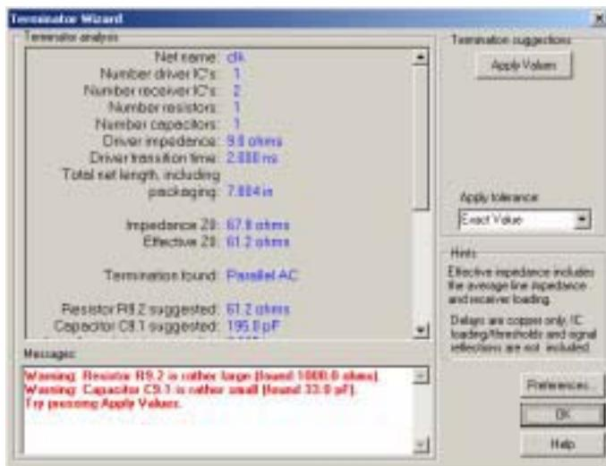
当您运行端接向导的时候，BoardSim 会自动地分析被选择的网络，并生成一个走线状态列表，在列表的底部，您可以看到它对端接的建议值。在这个例子中，向导可以正确地测定这个端接的类型是并行 AC (“parallel AC”) 端接。并计算出优化的建议 R 和 C 值，在计算中，BoardSim 可以自动地计算各种结果，如接收端 IC 的负载电容、总共的走线长度和驱动阻抗等等。
