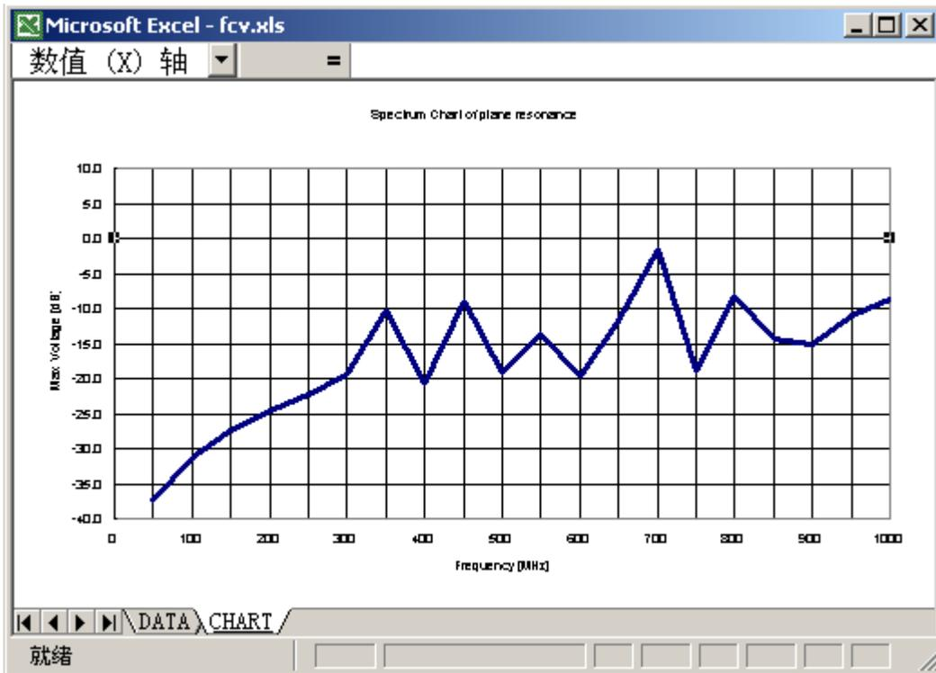
当然，各个频率点的振荡电压峰值也可以通过 Excel 表格的形式以数值的方式表达出来，如下图所示。例子中的频率值是以 50MHz 为步长进行增长的测试结果，当然您也可以根据您的需要随意设置其初始测试的频率值和步长的。
