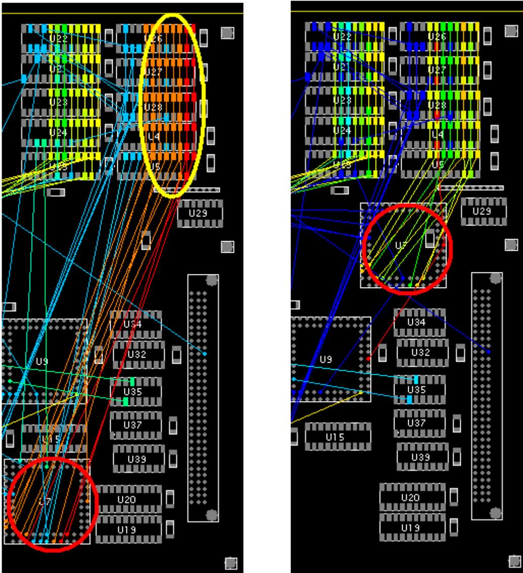
如上左图所示的红圈和黄圈内出现了许多网络标示为红色的错误。将红圈内的电路移动到如右图所示的更靠近黄圈的位置时，您可以发现错误数量减少了，网络颜色也变成了绿色。
