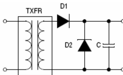
图 10: 变压器直流瞬变抑制
