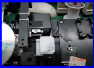
部分夹具使用了非防静电材料,如上图QC sppqc夹具静电压在100到500伏左右。
